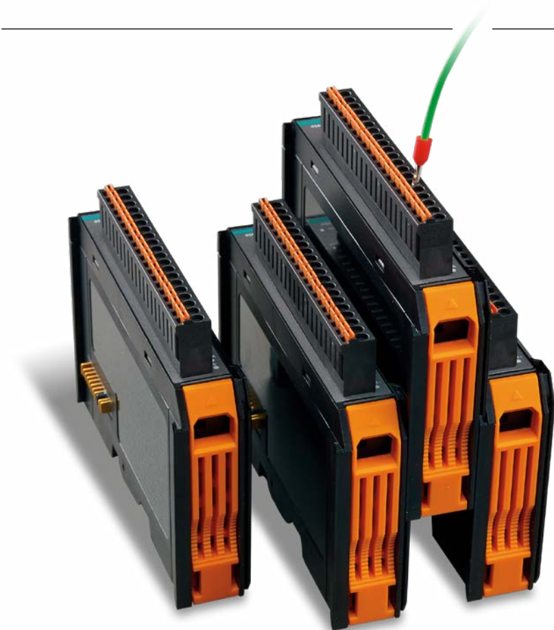
Het unieke mechanische ontwerp van deze ioThinX 4510 beperkt de tijd nodig voor montage en demontage. Schroevendraaiers en andere gereedschappen zijn in feite niet nodig, ook niet voor de bedrading.
