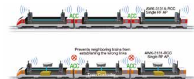
Met ACC moet elk toestel maar één enkele keer worden geconfigureerd, waarna het op gelijk welk rijtuig in eender welke configuratie een link zal vormen.
